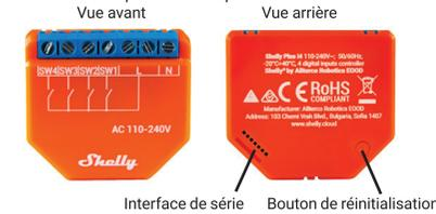
⚠️ **ATTENTION!** Haute tension. Ne vous connectez pas à l'interface de série lorsque le Shelly® Plus i4 est sous tension.
